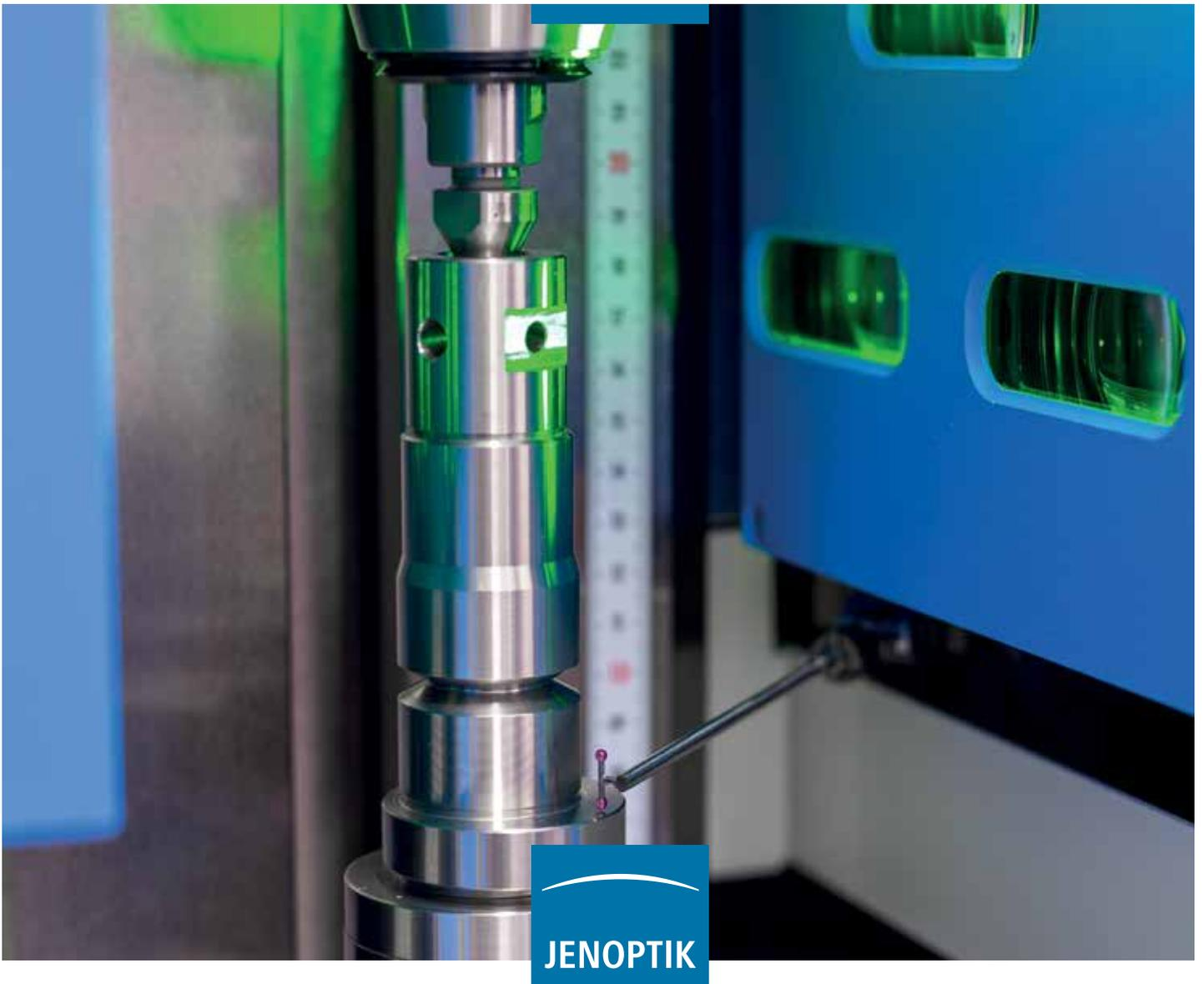
Opticline – 轴类件光学测量技术
