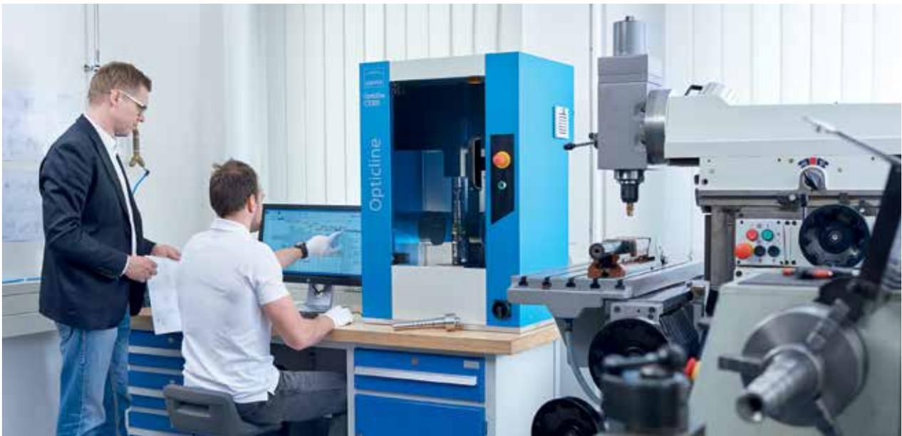
Opticline CS305 用于以经济方式测量长度最多 300 mm 的车削件
